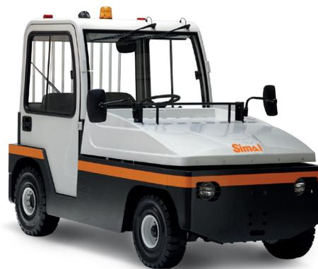
Trattore a 4 ruote, uomo a bordo. Alte prestazioni, ideale per i servizi pesanti a lungo raggio nei settori industriale ed aeroportuale. Il TE250R ha un'elevata capacità di traino pur avendo dimensioni e raggi di volta ridotti. La posizione posteriore della cabina consente una ottimale distribuzione dei pesi e un'eccellente stabilità. Pianale anteriore con capacità di carico 80 kg.
