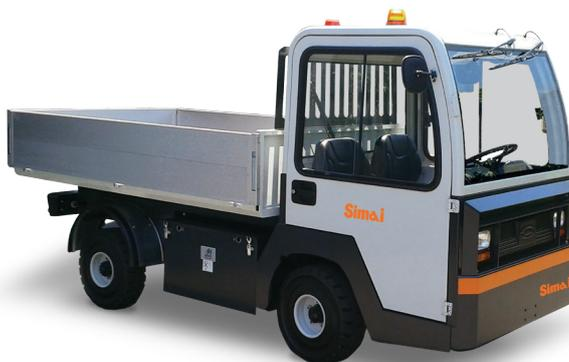
Trasportatore a pianale a 4 ruote, uomo a bordo, con trazione posteriore. Estremamente maneggevole, ideale per tutti i servizi - sia all'interno che all'esterno, anche su lunghi percorsi. Il trasportatore PE30 è predisposto per l'installazione di numerose attrezzature sul pianale.
