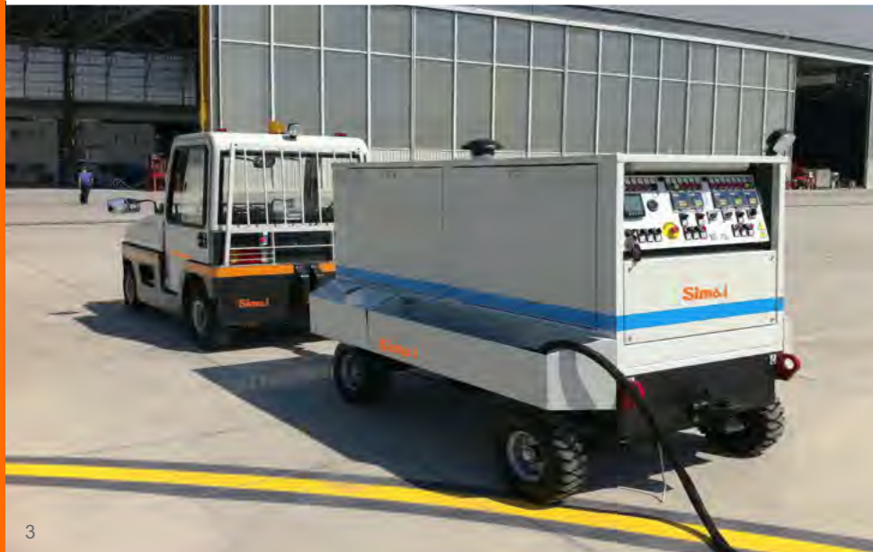
1) SIMAI TE250R-EA - Trattore per servizio di avviamento turbine aeromobili SIMAI TE250R-EA - Electric tow tractor for turbines starting duties 2) SIMAI TE80IXB-AE - Trattore per servizio di avviamento turbine aeromobili SIMAI TE80IXB-AE - Electric tow tractor for turbines starting duties
