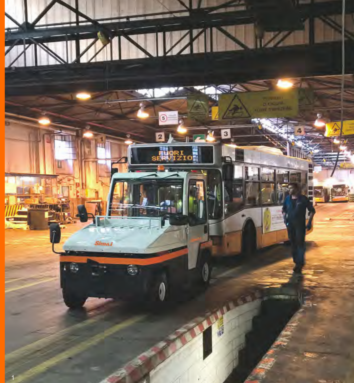
1) SIMAI TE250R - In allestimento per servizi di manutenzione autobus/camion SIMAI TE250R - In special configuration for bus/lorry maintenance
