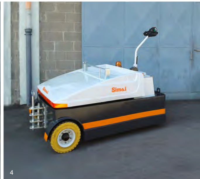
3) SIMAI TE151EA - Trattore con GPU integrato SIMAI TE151EA - Tow tractor with integrated GPU 4) SIMAI TTE250UP - Trattore pushback con operatore accompagnante SIMAI TTE250UP - Pushback tractor for aircrafts and fighter jets 5) SIMAI TE250R-EA - Trattore per servizio di avviamento turbine aeromobili SIMAI TE250R-EA - Electric tow tractor for turbines starting duties
