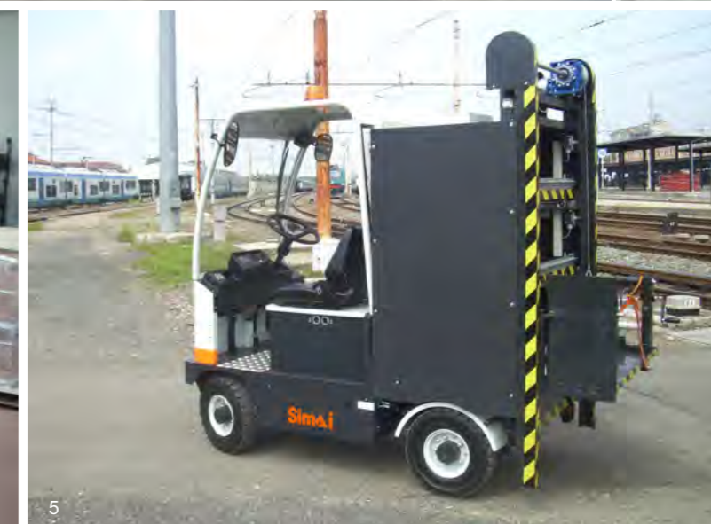
3) SIMAI TE40PERSOB - Piattaforma sollevabile radiocomandata per smontaggio componenti sottocassa rotabili SIMAI TE40PERSOB - Remote-controlled lifting platform to dismount trains' engines
