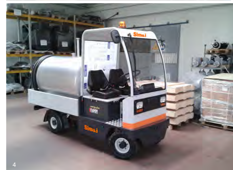
1) SIMAI TEEMPG-S - Mezzo per manutenzione pantografi e tetti rotabili ferroviari SIMAI TEEMPG-S - Trains' pantograph & roofs maintenance
