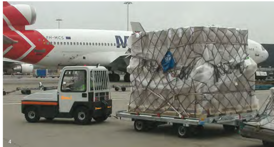
3) SIMAI GPU2000-60 - Centralina di messa a terra SIMAI GPU2000-60 - Ground power unit 4) SIMAI TE250R - Trattore per servizi di handling bagagli e cargo SIMAI TE250R - Electric tow tractor for ground & cargo handling
