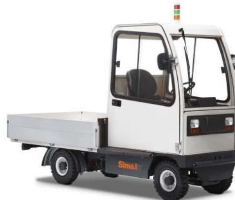
Vierrad-Plattformwagen, Bediener an Bord, Heckantrieb. Sehr kompakt und wendig, ideal für alle inner- und außerbetrieblichen Industrieinsätze, auch über lange Strecken. Der Plattformwagen kann durch zahlreiche Aufbauten an spezielle Einsatzprofile angepasst werden.
