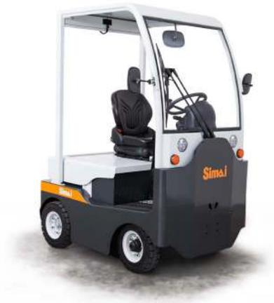
Vierrad-Schlepper, Bediener an Bord, Heckantrieb. Sehr kompakt und wendig, ideal für alle inner- und außerbetrieblichen Industrie-einsätze, auch über lange Strecken. Heckladefläche mit 100 kg Tragfähigkeit.
