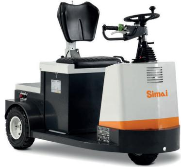
Tractor de 3 ruedas, con dispositivo "hombre presente" y tracción trasera. Extremadamente compacto y fácil de manejar, es ideal para trabajar con arreglo a los métodos Lean.
