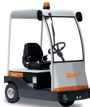
Tractor de 3 ruedas, con dispositivo "hombre presente" y tracción trasera. Extremadamente compacto y fácil de manejar, es ideal para todos los trabajos industriales – también al aire libre. Altura con techo de protección: mínima, para pasar incluso por el interior de túneles o puertas bajas.
