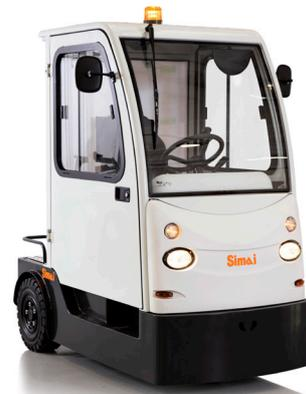
Dreirad-Schlepper, mit Bediener an Bord und Heckantrieb. Sehr wendig, ideal für den Intensiveinsatz, sowohl inner- wie auch außerbetrieblich. "AGV-fähig"
