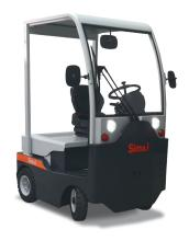
Tractor de 4 ruedas, con dispositivo "hombre presente" y tracción trasera. Extremadamente compacto y fácil de manejar, es ideal para todos los trabajos – tanto bajo techo como al aire libre e inclusive para trayectos largos. Plataforma trasera, con capacidad de carga de 100 kg.
