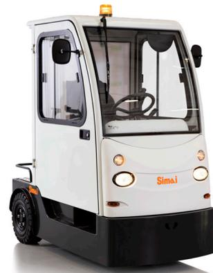
Tractor de 3 ruedas, hombre a bordo, con tracción trasera. Muy manejable, ideal para servicios intensivos tanto en interiores como en exteriores. "AGV ready"
