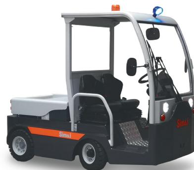
Tractor de 4 ruedas, con dispositivo "hombre presente" y tracción trasera. Extremadamente fácil de manejar, resulta ideal para todos los trabajos – tanto bajo techo como al aire libre. Es idóneo, en particular, para realizar los desplazamientos que requieren que el operador descienda con frecuencia a fin de efectuar las operaciones de enganche. Plataforma trasera con capacidad de carga de 100 kg.
