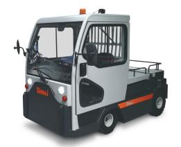
Tractor de 4 ruedas, con dispositivo "hombre presente" y tracción trasera. Es ideal para todos los trabajos intensivos - tanto bajo techo como al aire libre. Amplia plataforma trasera, con una capacidad de carga de 200 kg.
