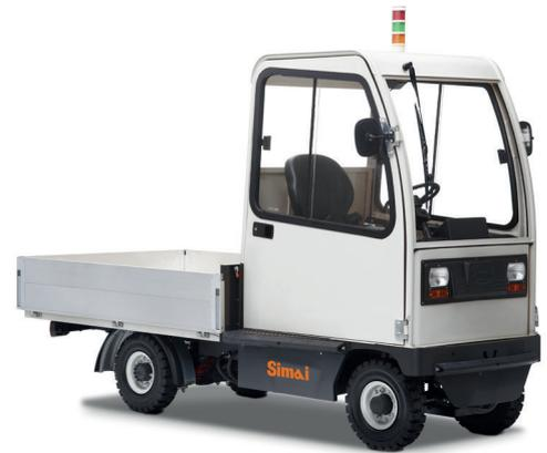
Transportador de 4 ruedas con plataforma. Con dispositivo "hombre presente" y tracción trasera. Extremadamente compacto y fácil de manejar, es ideal para todos los trabajos – tanto bajo techo como al aire libre, incluso para recorrer trayectos largos. El transportador PE15 viene preparado de fábrica para instalar numerosos equipos en la plataforma.
