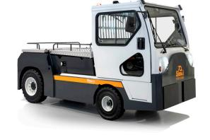
Trattore a 4 ruote, uomo a bordo. Alte prestazioni, ideale per i servizi pesanti a lungo raggio nei settori industriale ed aeroportuale. Il **TE501** ha un'elevata capacità di traino di 50 tonnellate con dimensioni e raggi di volta contenuti.
