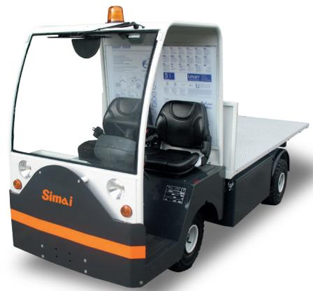
Transportador de 4 ruedas con plataforma. Con dispositivo "hombre presente" y tracción trasera. Extremadamente compacto y fácil de manejar, es ideal para todos los trabajos - tanto bajo techo como al aire libre, incluso para recorrer trayectos largos. El transportador PE20 viene preparado de fábrica para instalar numerosos equipos en la plataforma.
