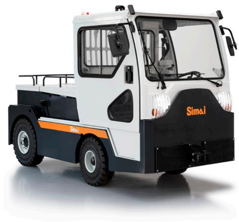
Vierrad-Schlepper, mit Bediener an Bord. Hochleistungsschlepper, ideal für schwere Einsätze über lange Strecken im Flughafen- und Industriebereich. Der **TE293** besitzt trotz geringen Abmessungen und Wenderadius eine Zugkraft von 29 t. Große Heckladefläche mit 200 kg Tragfähigkeit.
