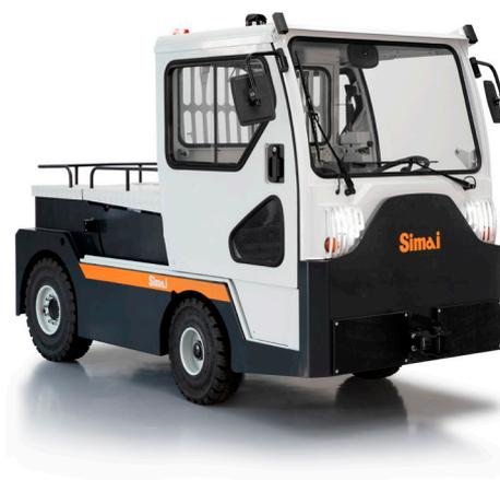
Trattore a 4 ruote, uomo a bordo. Alte prestazioni, ideale per i servizi pesanti a lungo raggio nei settori industriale ed aeroportuale. Il **TE293** ha un'elevata capacità di traino di 29 tonnellate pur avendo dimensioni e raggi di volta ridotti.
