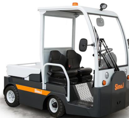
Tractor de 4 ruedas, con dispositivo "hombre presente" y tracción trasera. Extremadamente fácil de manejar, resulta ideal para todos los trabajos - tanto bajo techo como al aire libre. Es idóneo, en particular, para realizar los desplazamientos que requieren que el operador descienda con frecuencia a fin de efectuar las operaciones de enganche.
