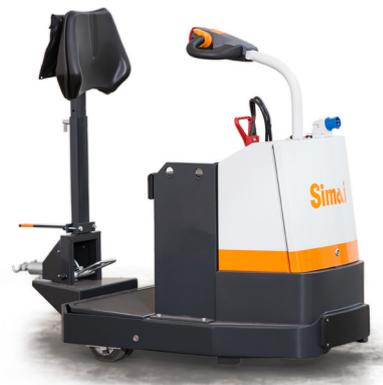
Dreirad-Schlepper, Bediener an Bord, Frontantrieb. Sehr schnell, kompakt und wendig, ideal für den leichten innerbetrieblichen Einsatz über kurze Strecken.
