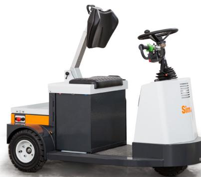
Tracteur à 3 roues, «homme à bord», avec traction arrière. Extrêmement compact et maniable, idéal pour les services de manutention LEAN.
