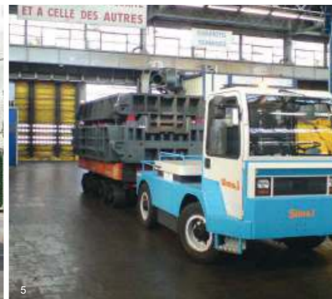
4) SIMAI PEB350 - Porteur pour bobines avec une capacité de 35 tonnes SIMAI PEB350 - Spulentransporter mit 35 Tonnen Ladefähigkeit 5) SIMAI TE800C - Tracteur électrique avec capacité de traction 80 ton SIMAI TE800C - Elektroschlepper mit 80 Tonnen Zugkraft 6) SIMAI TE100GS - Tracteur avec crochet de levage SIMAI TE100GS - Schlepper mit höhenverstellbarer Anhängerkupplung
