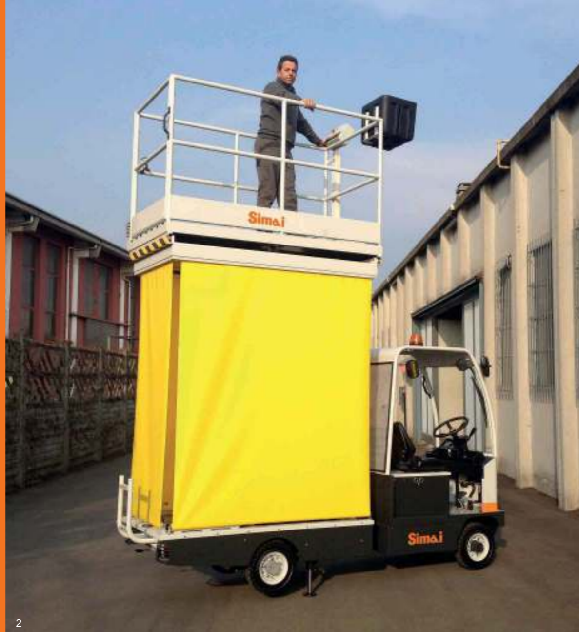
2) SIMAI PE12PS - Porteur à plateau avec plateforme de levage pour l'entretien des fenêtres des trains SIMAI PE12PS - Pritschewagen mit Hebebühne für die Wartung von Schienenfahrzeugfenstern
