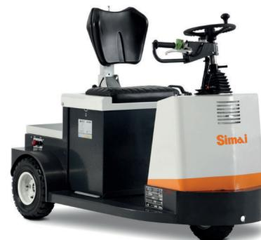
Trattore a 3 ruote, uomo a bordo, con trazione posteriore. Estremamente compatto e maneggevole, ideale per i servizi di movimentazione LEAN.
