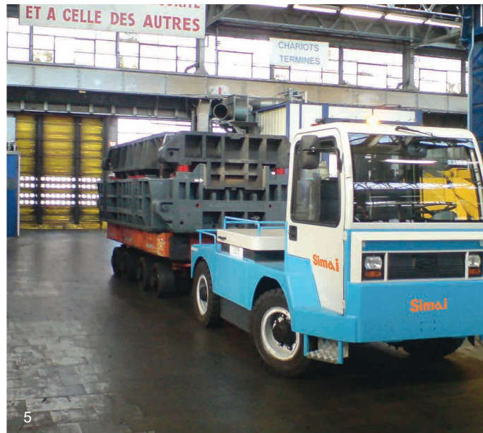
4) SIMAI PEB350 - Trasportatore per coils con portata 35 ton SIMAI PEB350 - 35-tons loading capacity coils carrier 5) SIMAI TE800C - Trattore elettrico con capacità di traino 80 ton SIMAI TE800C - 80 tons towing capacity heavy duty tractor 6) SIMAI TE100GS - Trattore con gancio sollevabile SIMAI TE100GS - Towing tractor with lifting hitch
