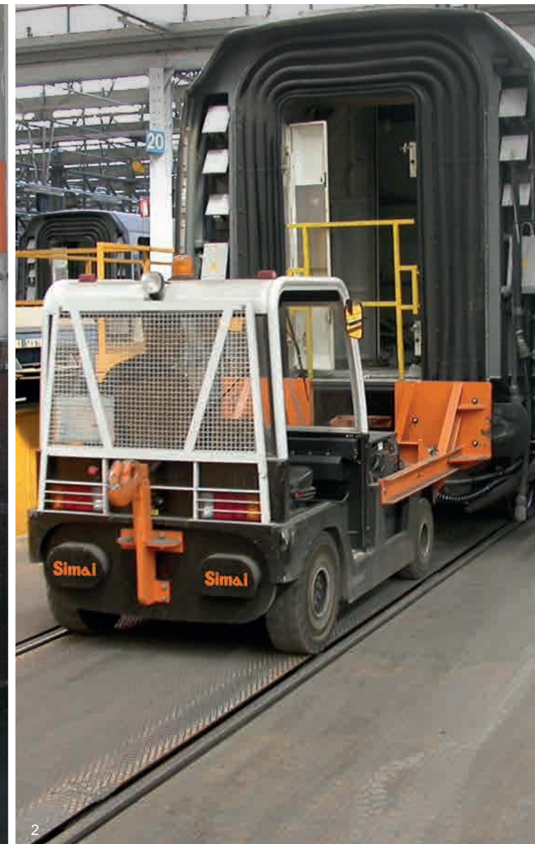
3) SIMAI TE30PERLA - Piattaforma sollevabile per smontaggio componenti sottocassa radiocomandata o con guida a timone SIMAI TE30PERLA - Pedestrian operator or remote controlled lifting platform to dismount trains components
