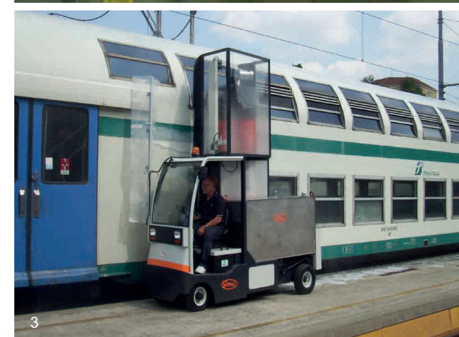
1) SIMAI TE70IXB-AE - Trattore per servizio avviamento convertitori rotabili ferroviari SIMAI TE70IXB-AE - Tow tractor with specific equipment to start trains' converters
