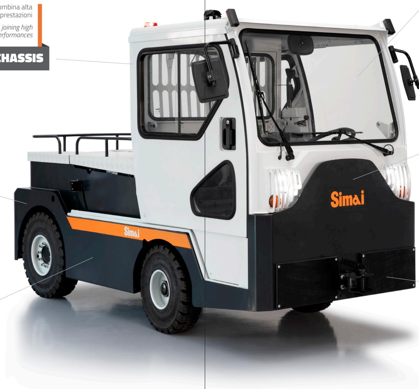
Il TE252, potente trattore elettrico a quattro ruote con capacità di traino di 25 tonnellate, è stato sviluppato studiando le necessità degli operatori del ground handling aeroportuale. Tutte le soluzioni innovative utilizzate nella progettazione del TE252 sono state scelte per garantire ai clienti la massima qualità, un'aumentata produttività e una sicurezza maggiorata, riducendo al contempo il costo operativo del trattore.
