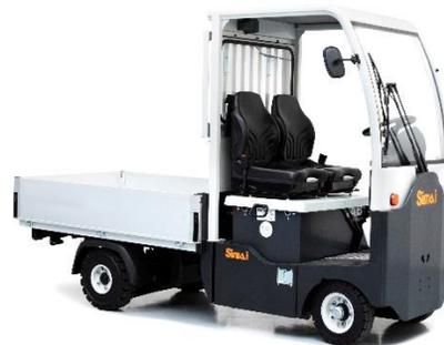
Trasportatore a pianale a 4 ruote, uomo a bordo, con trazione posteriore. Estremamente compatto e maneggevole, ideale per tutti i servizi - sia all'interno che all'esterno, anche su lunghi percorsi. Il trasportatore PE15.1 è predisposto per l'installazione di numerose attrezzature sul pianale.
