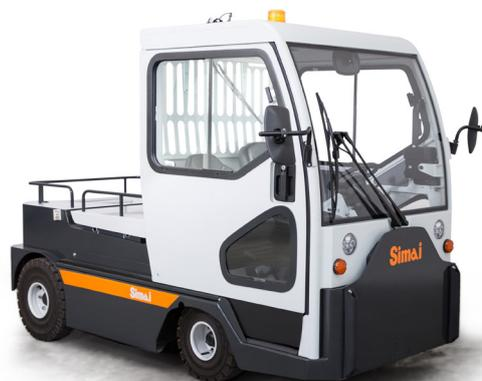
Trattore a 4 ruote, uomo a bordo, con trazione posteriore. Ideale per tutti i servizi intensivi – sia all'interno che all'esterno. Ampio pianale posteriore con capacità di carico 200 kg.
