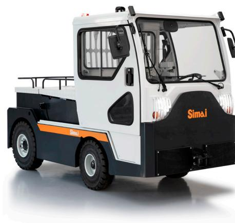
Tractor de 4 ruedas, hombre a bordo. Altas prestaciones, ideal para servicios pesados de largo radio en los sectores industrial y de aeropuerto. El **TE252** tiene una elevada capacidad de arrastre de 25 toneladas aún con dimensiones y radios de giro reducidos. Amplia plataforma trasera con capacidad de carga 200 kg.
