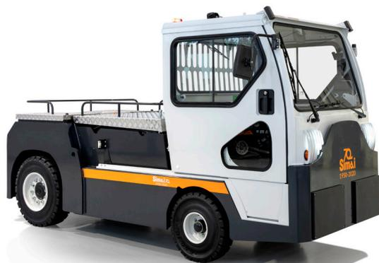
Trattore a 4 ruote, uomo a bordo. Alte prestazioni, ideale per i servizi pesanti a lungo raggio nei settori industriale ed aeroportuale. Il **TE501** ha un'elevata capacità di traino di 50 tonnellate con dimensioni e raggi di volta contenuti.
