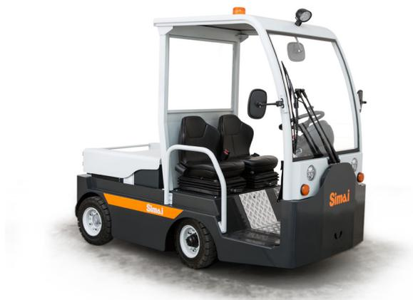
Vierrad-Schlepper, Bediener an Bord, Heckantrieb. Sehr wendig, ideal für alle inner- und außerbetrieblichen Industrieinsätze. Besonders geeignet für Einsätze, die ein häufiges Ein- und Aussteigen des Bedieners für das An- und Abkuppeln erfordern. Heckladefläche mit 100 kg Tragfähigkeit.
