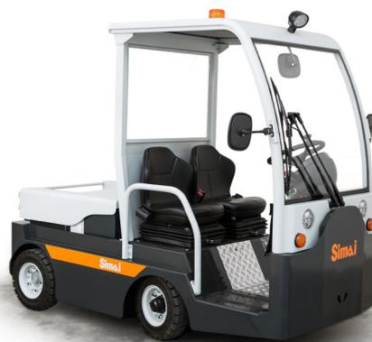
Trattore a 4 ruote, uomo a bordo, con trazione posteriore. Estremamente maneggevole, ideale per tutti i servizi - sia all'interno che all'esterno. Particolarmente idoneo per le movimentazioni in cui l'operatore deve frequentemente scendere per le operazioni di aggancio. Pianale posteriore con capacità di carico 100 kg.
