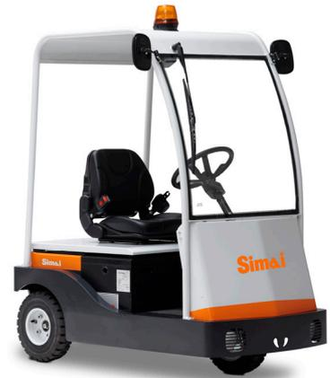
Dreirad-Schlepper, Bediener an Bord, Heckantrieb. Sehr kompakt und wendig, ideal für alle - auch außerbetrieblichen - Industrieein-sätze. Extrem beschränkte Höhe mit Schutzdach für Arbeiten in Tunnels bzw. in niedrigen Arbeitsräumen.
