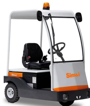
Trattore a 3 ruote, uomo a bordo, con trazione posteriore. Estremamente compatto e maneggevole, ideale per tutti i servizi industriali - anche all'esterno. Altezza con tetto di protezione estremamente limitata per operare anche in tunnel o portali ad altezza ridotta.
