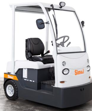
Dreirad-Schlepper, mit Bediener an Bord und Heckantrieb. Sehr kompakt und wendig, ideal für alle inner- und außerbetrieblichen Industrieeneinsätze.
